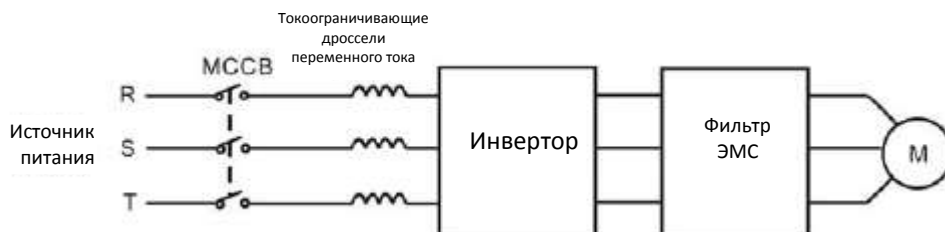
Рисунок 4.18. Электромонтаж силовой цепи электродвигателя
